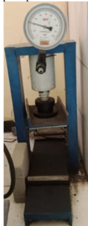
Gambar 3. Alat Uji Kuat Lentur
