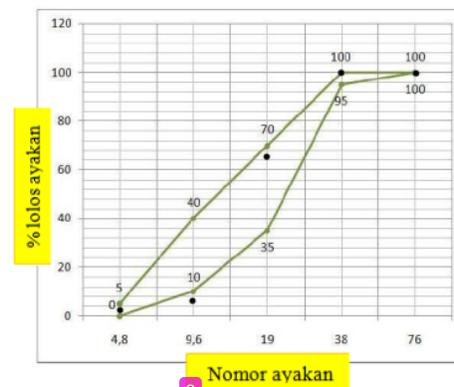
Gambar 4. Gradasi kerikil ukuran maksimum 40 mm
