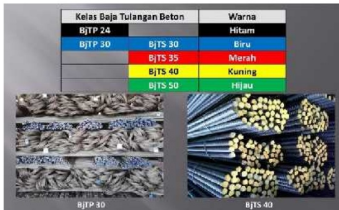
Gambar 25 Kelas Baja Tulangan Beton
