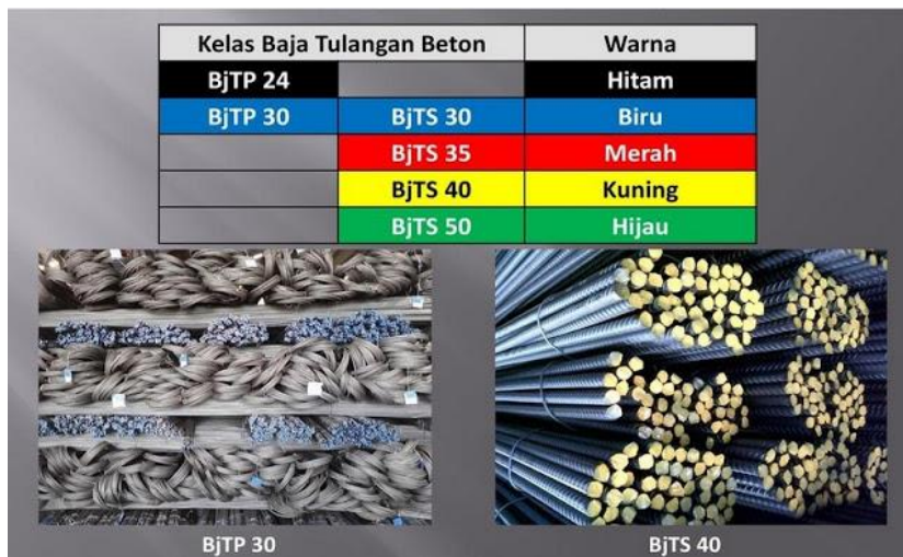
Gambar 25 Kelas Baja Tulangan Beton
