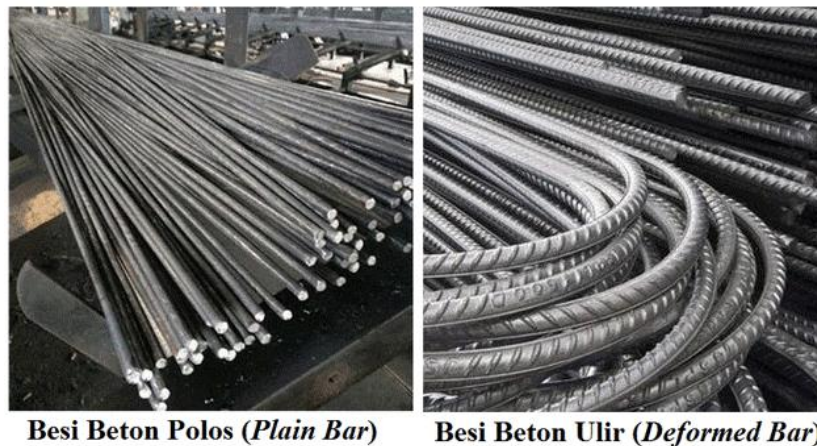
Gambar 24 Besi Beton Polos dan Ulir
