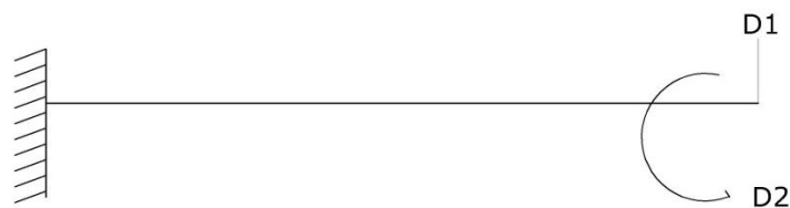
Gambar 2.12 Derajat Ketidak Tentuan Kinematis : 2
