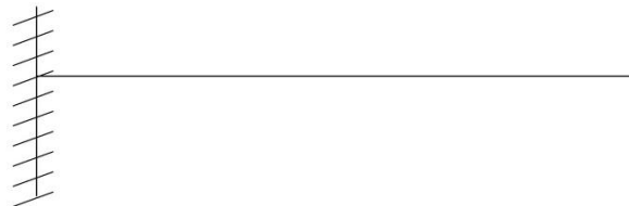
Gambar 2.11 Struktur Dasar Yang Dikekang
