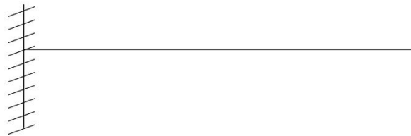
Gambar 2.11 Struktur Dasar Yang Dikekang
