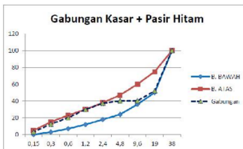
Gambar 4. Grafik Gradasi Gabungan Agregat
