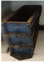
Gambar 1. Alat Cetak Pembuatan Balok Beton Ukuran 150 mm x 150 mm x 600 mm
