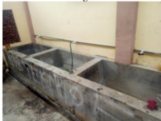
Gambar 2. Tempat Curing Beton
