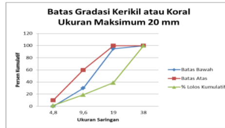
Gambar 9. Batas Gradasi Kerikil Ukuran Maksimum 20 mm Sumber: Hasil Pengolahan Data (2020)
