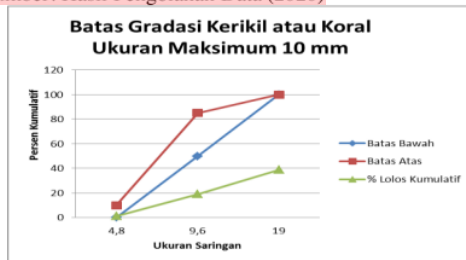
Gambar 8. Batas Gradasi Kerikil Ukuran Maksimum 10 mm Sumber: Hasil Pengolahan Data (2020)
