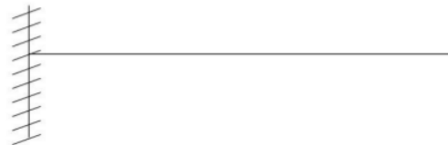
Gambar 2.11 Struktur Dasar Yang Dikekang
