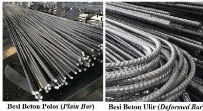
Gambar 24 Besi Beton Polos dan Ulir
