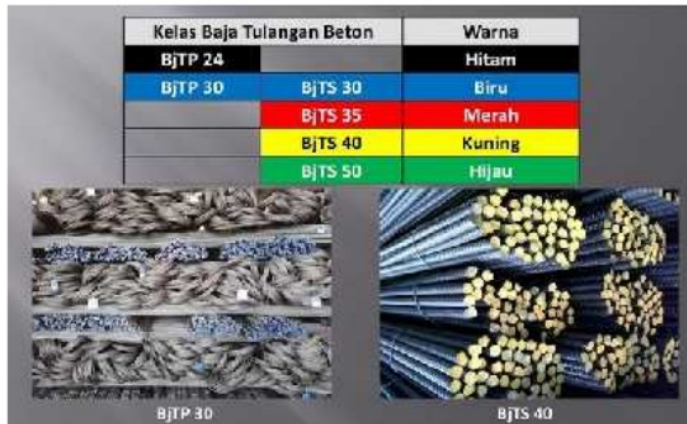
Gambar 25 Kelas Baja Tulangan Beton
