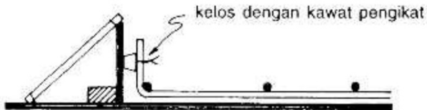
Gambar 49 Penutup Beton dengan Penahan Jarak (Sumber : Segel, Kole, & Kusuma, 1993)
