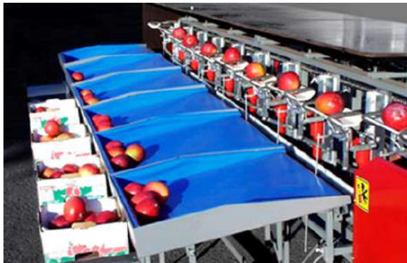
Gambar 3.1: Mesin Sortir Dengan Memanfaatkan Ukuran Diameter Buah Apel ( https://www.caustier.com/grading/grading-machine-tropica/52.html )
