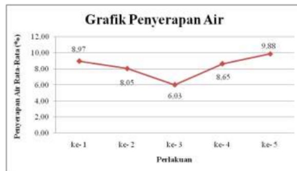
2 Gambar 2. Grafik Penyerapan Air Paving Block (Sumber : Analisis Data, 2018)
