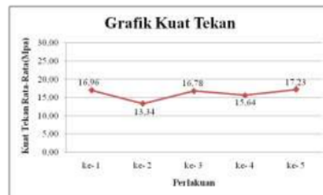
Gambar 1. Grafik Kuat Tekan Paving Block (Sumber : Analisis Data, 2018)
